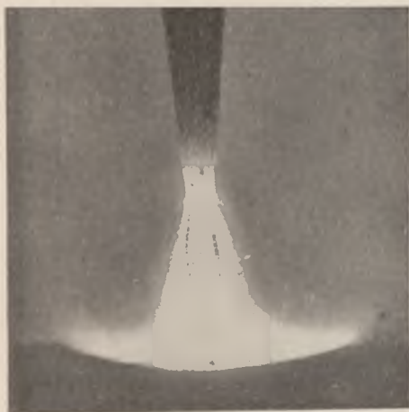
Rys. 1. Łuk spawalniczy przy elektrodzie węglowej.
