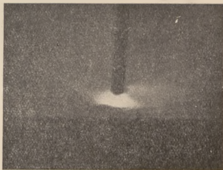
Rys. 6. Łuk spawalniczy przy gołej elektrodzie metalowej.
