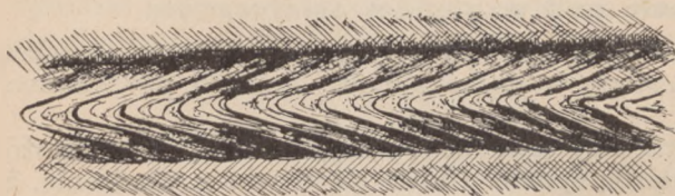
Rys. 33. Spoina wadliwa i nieestetyczna, z powodu nadmiernego natężenia prądu.
