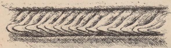
Rys. 34. Spoina wadliwa i nieestetyczna, ułożona przy użyciu nadmiernego natężenia prądu; kierunek układania się stopiwa odchylony z powodu magnetycznego działania łuku.
