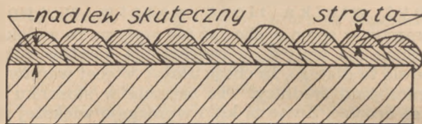
Rys. 30. Nieoszczędny sposób nakładania powierzchni.
