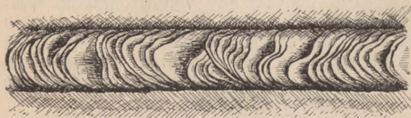
Rys. 36. Spoina o nieregularnych rysach, powstałych skutkiem nierównych ruchów poprzecznych elektrodą i niejednakowej długości łuku.
