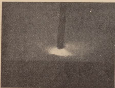
Rys. 2. Łuk spawalniczy przy gołej elektrodzie metalowej.
