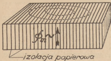
Rys. 2. Przeciwdziałanie tworzeniu się prądów wirowych przez podział masy przewodnika na cienkie blachy izolowane od siebie papierem.
