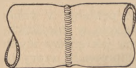
Rys. 18. Odkształcenie spawanych rur grubościennych.
