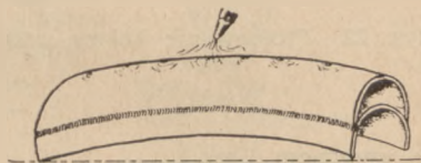
Rys. 21. Nagrzewanie rynnny w celu jej wyprostowania.
