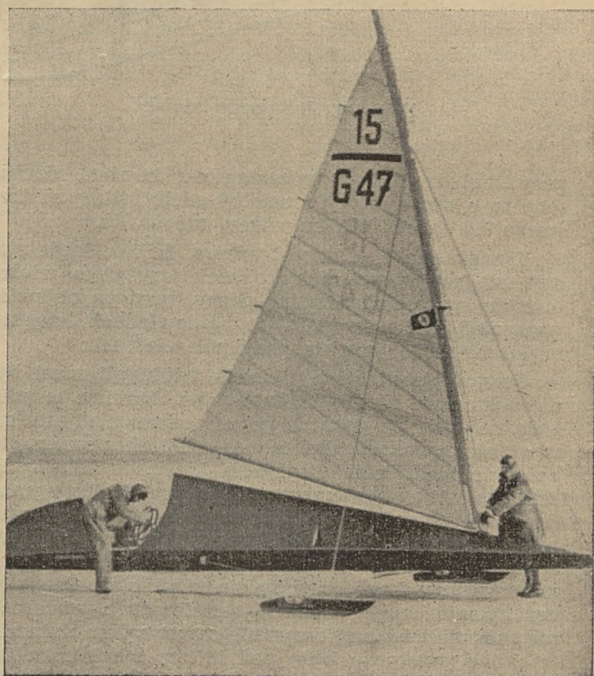
Współczesny bojer niemiecki klasy wolnej 15 metrów kwadratowych żagla. Posiada podwójne sterowanie, dzięki czemu kadłub można odchyłać wraz z bomem od osi ruchu i wówczas powierzchnia jego pracuje jak żagiel
