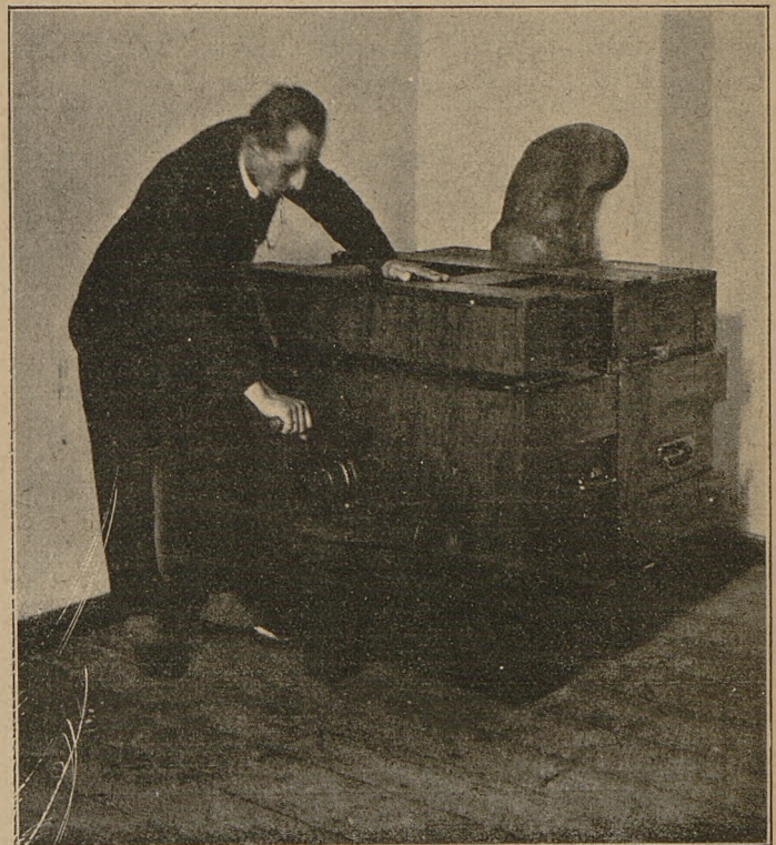
Rys. 3. Obsługujący wprowadza do pomieszczenia czyste powietrze przez filtr skrzynkowy, poruszając rączką wentylatora.
