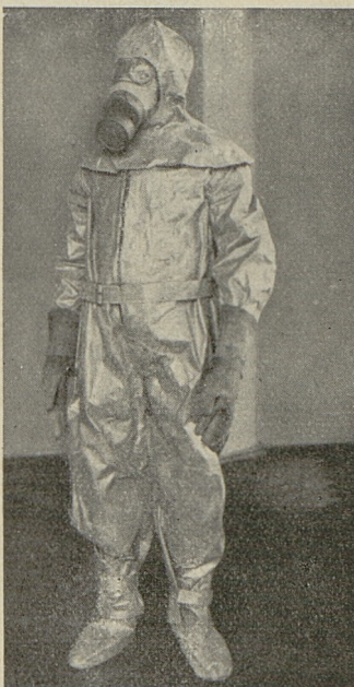
Ubranie przeciwiiperytowe impregnowane gumą (wadliwe uszczelnienie głowy — zbyt sztywne).
