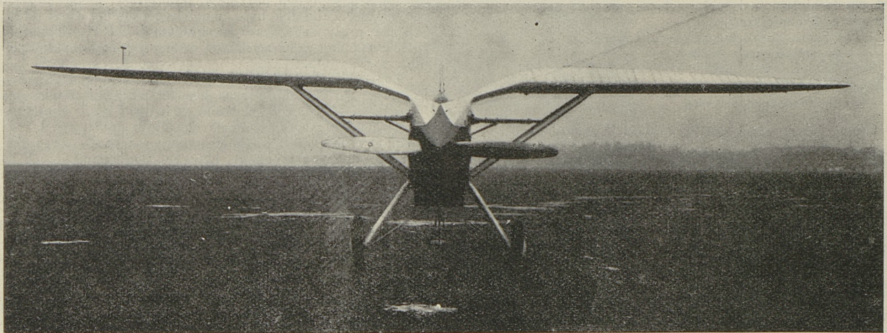
Państwowe Zakłady Lotnicze w Warszawie wypuściły swojej własnej konstrukcji płatowiec pościgowy całkowicie metalowy.
