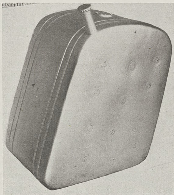
1000-litrowy zbiornik wagi 28 kg, do pławca transportowego. Materiał—blacha AM 503.
