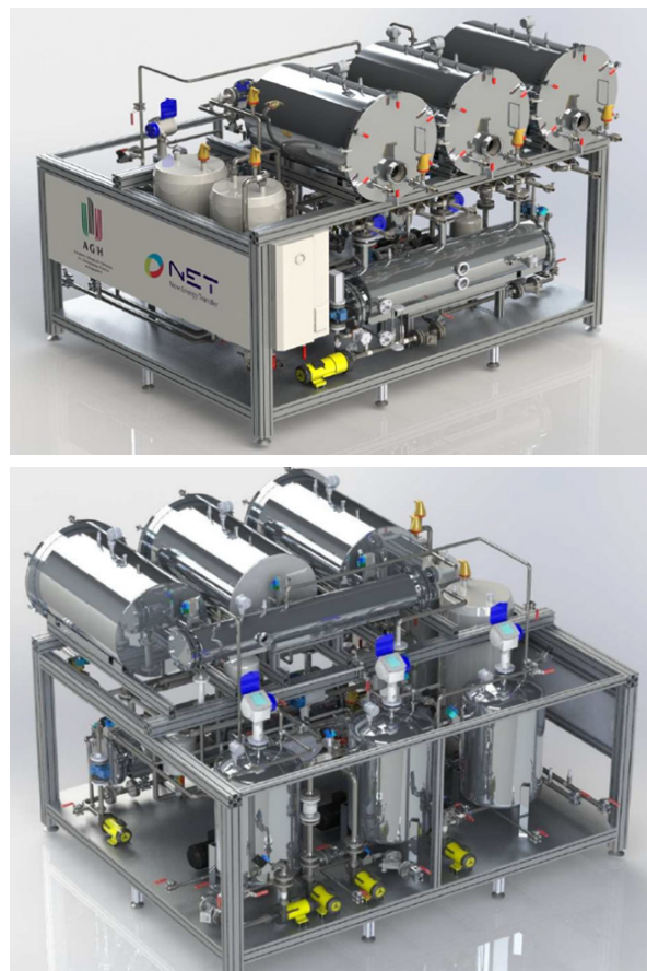
Rys. 8. Chłodziarka adsorpcyjna z funkcją odsalania w Centrum Energetyki AGH
