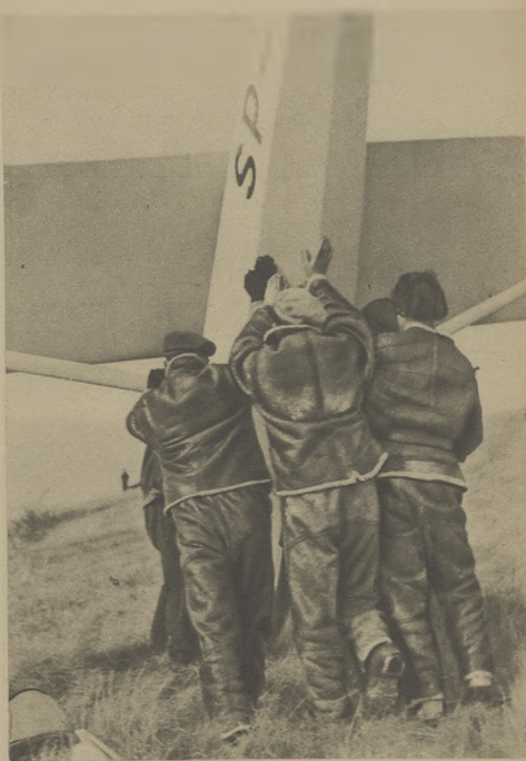
Jak się okazuje, szybowiec przy lądowaniu został lekko uszkodzony — nadłamanie płoty. Trzeba go odwrócić „na plecy” aby wymienić uszkodzony liogment
