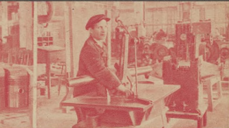
PO WYKONANIU OBRÓBK MECHANICZNEJ CZĘŚCI GOTOWE ZOSTAJĄ SKIEROWANE NA MONTAŻ GDZIE ZOSTAJĄ WMONTOWANE POD ZESTOŁEM, Z KTYÓRYCH POWSTAJE TRAKTOR NA ZDJĘCIU MONTAŻ ŁOŚKA. W TEJ SAMEJ HALLI MONTAŻOWEJ DOKONYWUJE SIĘ RÓWNIEM PASOWANIE KORBOWO DO WAŁ KORBOWY
