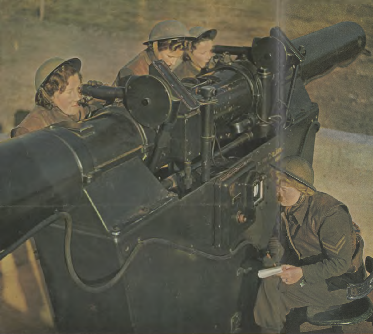
Oto członkinie Pomocniczej Służby Terytorialnej (A.T.S.); służą one w wielkiej liczbie w mieszanych bateriach p. lot. w W Brytanji. Na zdjęciu widać zespół czterech dziewcząt obsługujących maernik wysokości.
