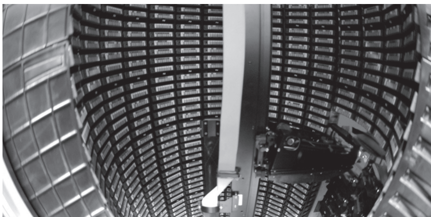
Fot. 2. Przykład rozbudowanej i całkowicie zautomatyzowanej biblioteki taśmowej
