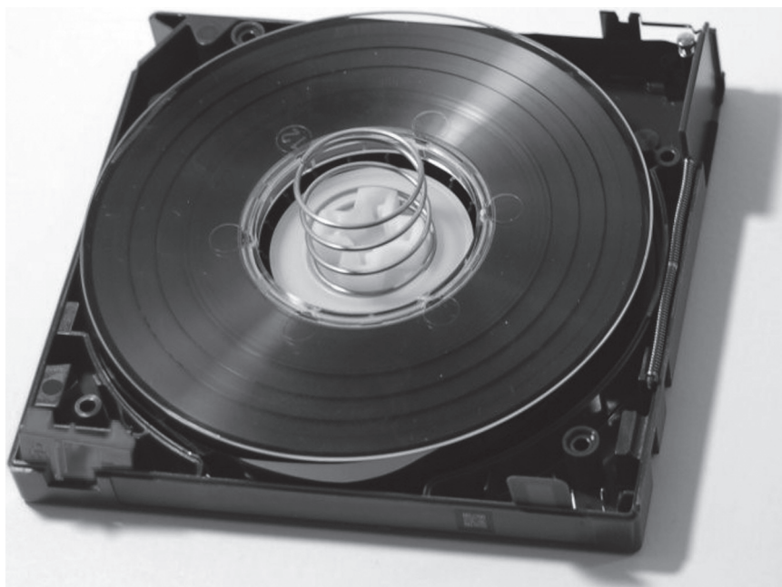
Fot. 1. Taśma magnetyczna w obudowie LTO drugiej generacji ze zdjętą pokrywą Źródło: (Austinmurphy, 2008).
