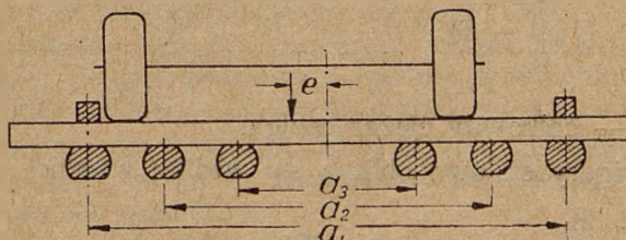
Rys. 11. Schemat poprzecznego ustawienia ciężarów na moście
