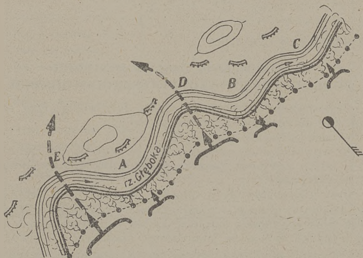
Rys. 1. Maskowanie zasłoną dymną działań jednostek skoncentrowanych przed przeprawą w terenie otwartym: A, B, C — zasłony pozorne; D i E — zasłony rzeczywiste.
