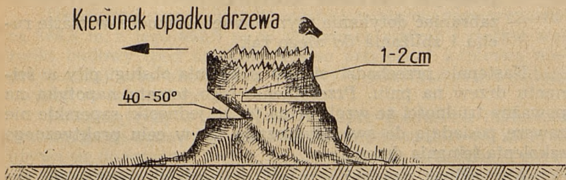
Rys. 1. Sposób ścinania drzewa na pniu
