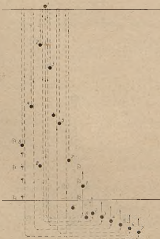
Rys. 4. Praca zastępu przy wykonywaniu przejścia dla czołgów
