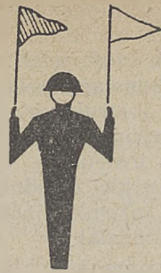
„UWAGA - SPRAWDZENIE PRZEWODNOŚCI”
