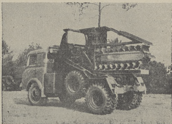
Rys. 9. Wieloczerpakowa koparka Matenin typ 600 w położeniu marszowym
