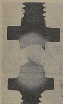
Rys. 12. Zniszczenie styków platynowych przez prąd jednokierunkowy.
