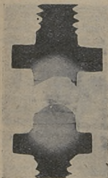
Rys. 12. Zniszczenie styków platynowych przez prąd jednokierunkowy.
