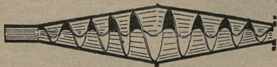
Rys. 10. Tłumik ze spiralą, pozwalającą na ekspansję gazów i dławienie w drugiej połowie.
