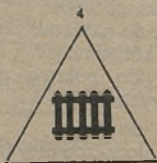
Strzeżony przejazd kolejowy
