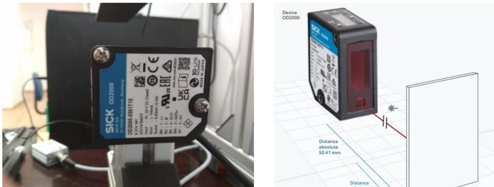
Fig. 4. Sensor SICK OD2000-0501T15
