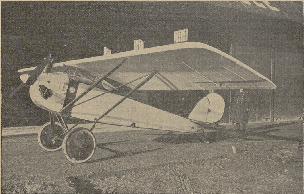
Samolot słabos'lnikowy Avionett'ka Tow. Lotniczego z silnikiem trzycylindrowym „Mark“ 30 MK., chłodzony powietrzem, napędzany benzolem, dzięki czemu jest nader ekonomiczny.
