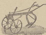
Rys. 16. Wyorywacz do buraków Pracnera.
