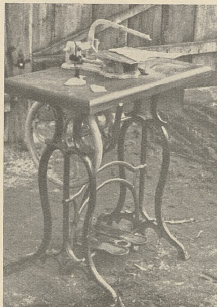
Kol. Pichol wymyślił na podobieństwo maszyny do szycia — maszynę do cięcia dykty.
