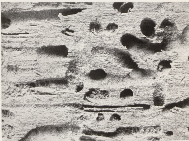
Ryc. 7—8. Zdjęcia w powiększeniu mikroskopowym tkanki drewna przed i po impregnacji.
