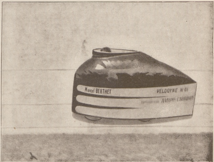
Francuski kolarz Marceli Berthet skonstruował specjalną, profilowaną karoserję na rower, która waży 10 kg. i, dzięki zmniejszeniu oporu powietrza, pozwala osiągnąć bez wysiłku szybkość 50 klm/g.
