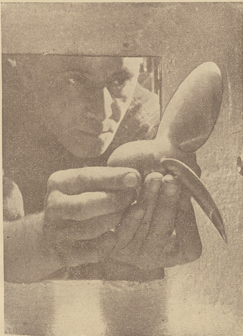
Zdjęcie nasze przedstawia śrubę modelu, przykręconą do wału napędowego, w tunelu doświadczalnym, gdzie wypróbowuje się ją w warunkach, identycznych z pracą na morzu. (Szczegóły na str. 16—17)
