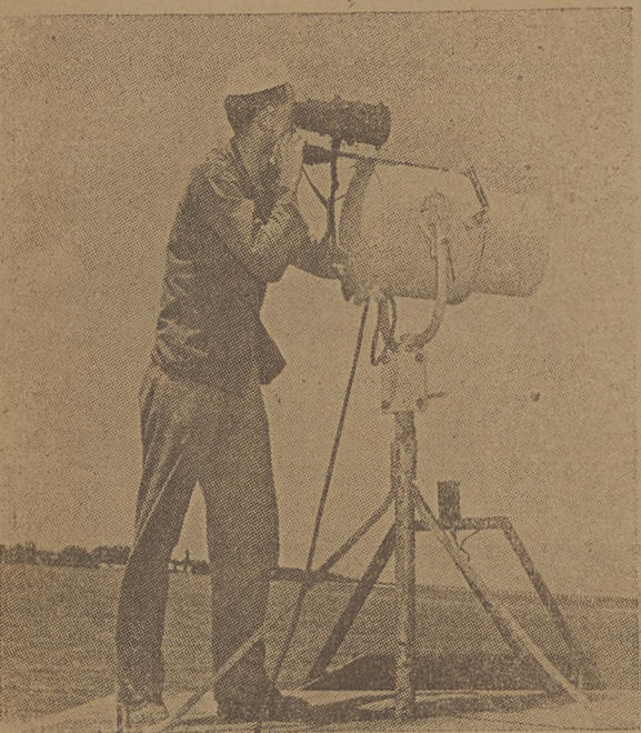
Infraczerwone światło sygnałowe wysyła promienie, które nie są widziane gołym okiem, lecz dzięki odbiornikowi.
