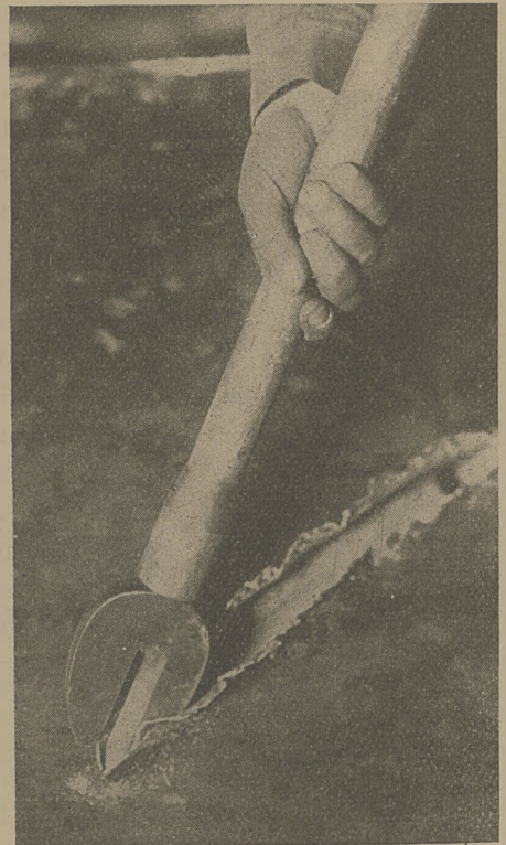
Fig. 7. Narzędzie do prucia kas metalowych, t. zw. rak, w czasie „roboty”.
