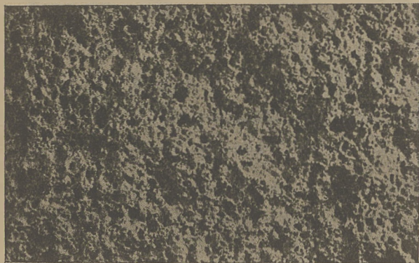
Fig. 1. Przełom bloku dimabetonowego, wielkość naturalna.
