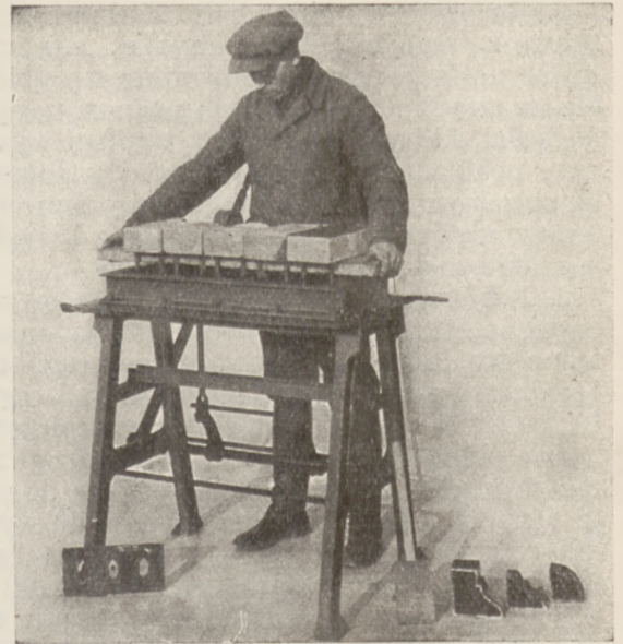
Fig. 3. Robotnik podkłada deseczkę pod podniesione cegły leżące na podkładkach blaszanych.
