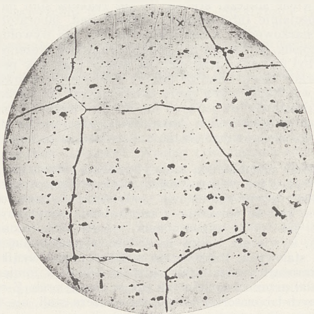
Rys. 1. Próbką przegrzana do 1300° C.
