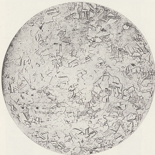
Rys. 4. Próbką zagrzana do 1050° C. i ochłodzona w wodzie
