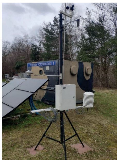
Rys. 2. Przenośna stacja meteorologiczna firmy A-STER znajdująca się w terenowym laboratorium fotowoltaicznym w Miękinii
