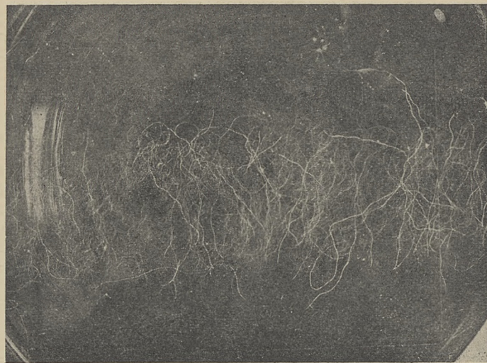
Fig. 5. Próbkę z fig. 4 zanurzoną w mieszaninie równych części nafty i ksylołu.
