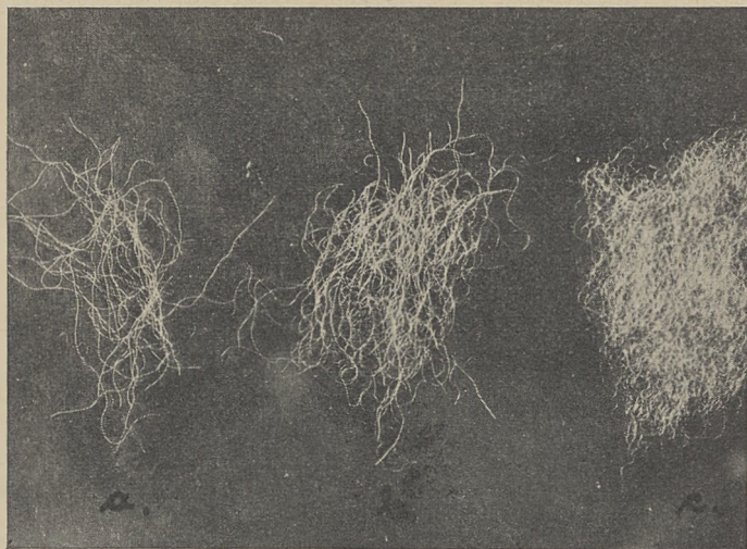
Fig. 6. Próba uwidoczniiona na fig. 4 po przeprowadzeniu analizy wełny przy zastosowaniu testu Elphicka:
