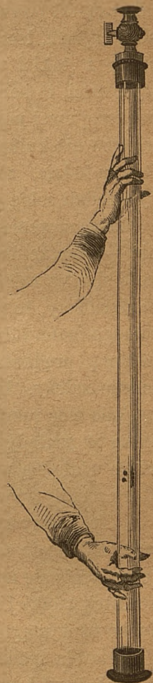
Fig. 3. Doświadczenie, pokazujące, że wszystkie ciała spadają w próżni z jednakową szybkością.
