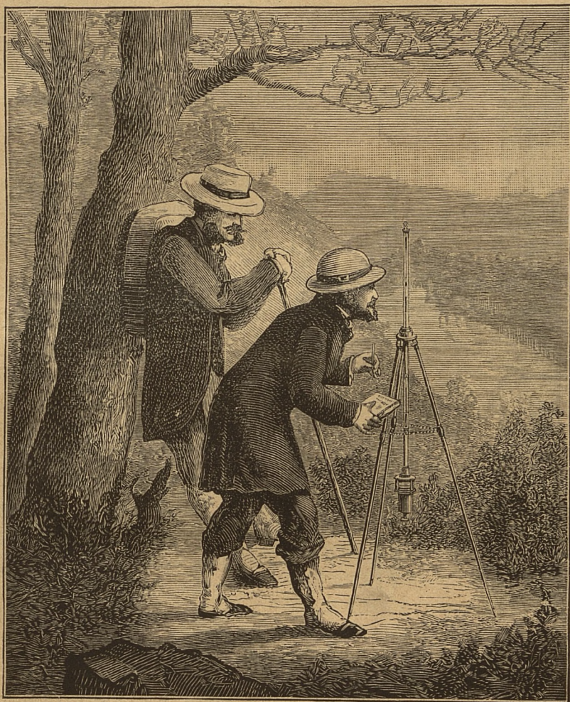
Fig. 117. Barometr Fortin'a. Ustawienie w podróży.
