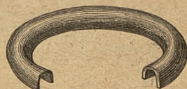
Fig. 55. Pierścień skórzany w prasie hydraulicznej.
