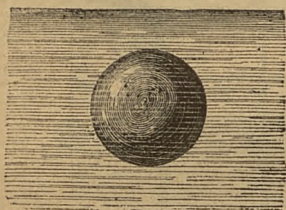
Fig. 97. Kształt cieczy, znajdującej się pod wpływem działania przeważającej spójności swych cząstek.
