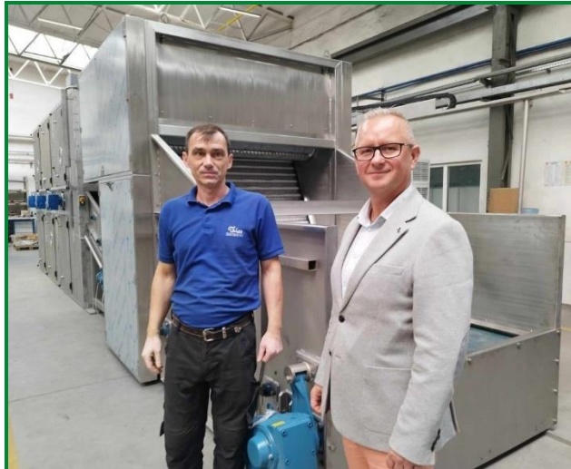
Zmodyfikowana suszarka bębnowa do suszenia włókien luźnych. W pierwotnej wersji Dofama produkowała takie suszarki od lat 60. XX w. Przy maszynie Ireneusz Kruczek, prezes oraz Marek Sikora, mistrz produkcji i instruktor nauki zawodu
