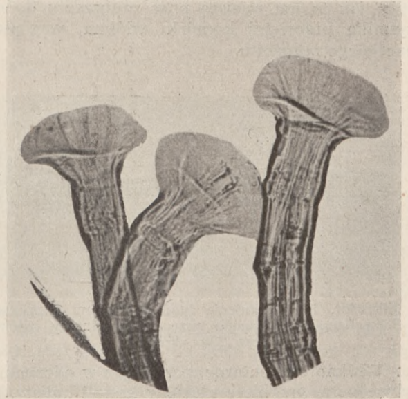
Mikrofot. 13. Wygląd włókienek elementarnych po pewnym czasie działania odczynnika Schweitzera. (Pow. 440-krotne).
