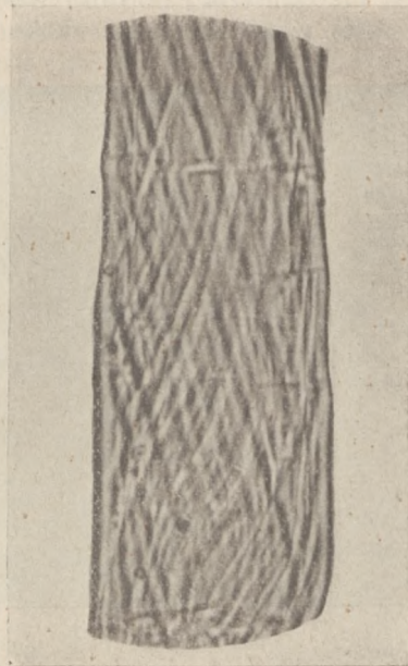
Mikrofot. 7. Spirale widoczne na komórce elementarnego włókna lnu. (Pow. 440-krotne).
