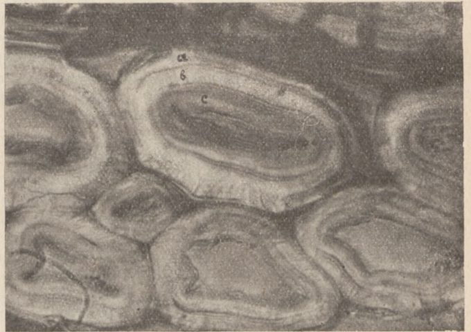
Mikrofot. 6. Uwarstwienie komórek włókna elementarnego w poprzecznym przekroju. (Powiększenie 500-krotne).
