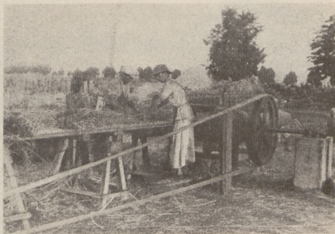
Jugosławia. Knežewo. Wielowalcowa (12 par) międłarka w pracy na wolnym powietrzu. Napęd 8 HP lokomobila.
