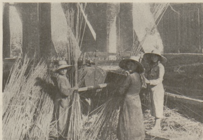
Italia. Ferrara. Podawanie słomy do dekortykatora syst. Opitz'a.
