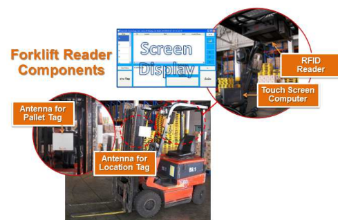
Fig. 8. Reader which mounted on the Forklift truck Rys. 8. Czytnik zamontowany na wózku widłowym
