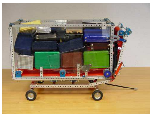
Fig. 2. The mechanized transport trolley. This solution was developed only until the prototype stage. Rys. 2. Zmechanizowany wózek transportowy. Rozwiązanie to nie wyszło poza fazę wykonania prototypu doświadczalnego.
