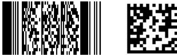
Fig. 2. The word "traceability" encoded in PDF417 (left) and Data Matrix (right) Codes. Rys. 2. Słowo „śledzenie” zakodowane kodem PDF417 (z lewej) oraz Data Matrix (z prawej).
