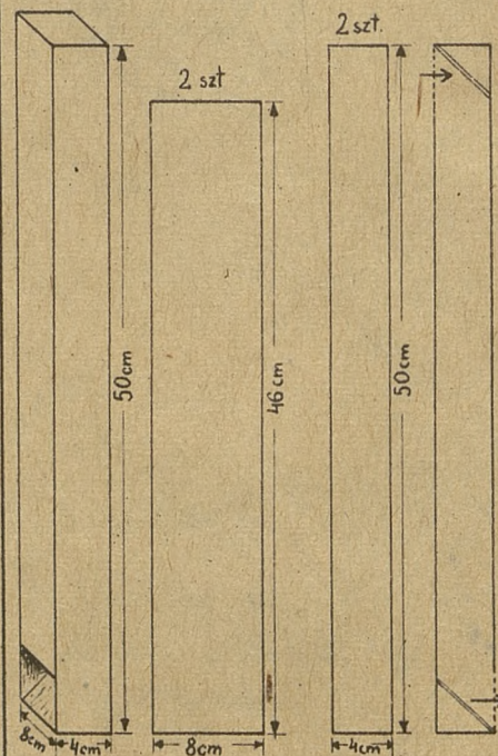
Rys. 2. Części składowe peryskopu
