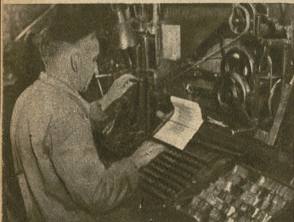
„Maszynka” — linotyp. Tutaj linotypista Ob. Tadeusz Zagórski zamienia teksty maszynopisu na metalowe wiersze.
