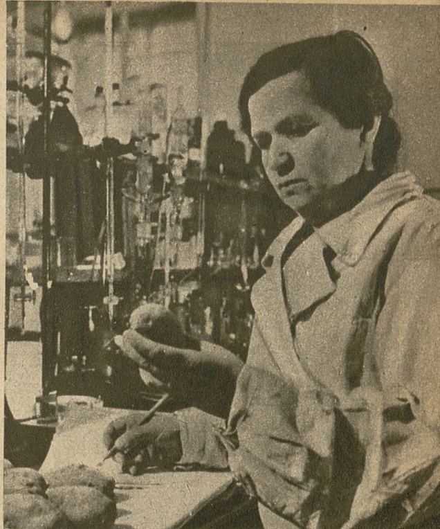
Instytut Naukowo-Badawczy Przemysłu Konserwowego ZSRR prowadzi z powodzeniem prace nad zastosowaniem energii atomowej do długotrwałego przechowywania warzyw. Na zdjęciu Lubow Archipowa, pracownik Instytutu, bada w laboratorium wpływ promieni gamma na ziemniaki.
