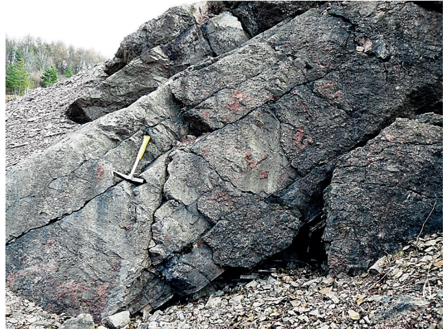
Fig. 12. Powierzchnia uskoku w dolomitach. Po prawej stronie zdjęcia widoczna brekcja tektoniczna, powstała w szczelinie uskoku (Fig. 1B, pkt 6), fot. Z. Złonkiewicz • Surface of a fault in dolomites. Tectonic breccia in a fault fissure visible on the right of the photo (Fig. 1B, stop 6), photo Z. Złonkiewicz
