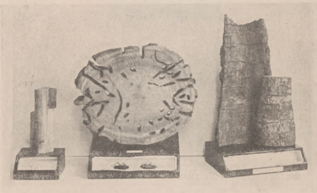
Rys. 4. Przykłady uszkodzeń — żery Kózkowatych i Kornikowatych.
