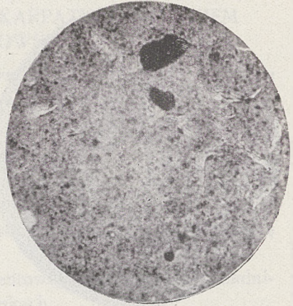
Fot. 6 i 6a. Mieszanka z 20% dodatkiem bitumu polskiego (bitum b). Białe plamki— krople oleiste nierozpuszczające się w smole.
