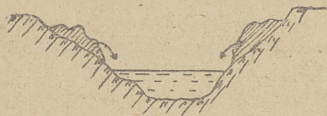
Rys. 4. Wadliwe odkładanie namułów. Rys. 5. Prawidłowe odkładanie namułów
