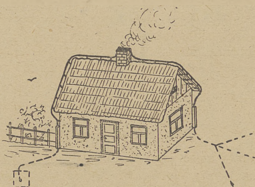
Piorunochron na budynku krytym dachówką.
