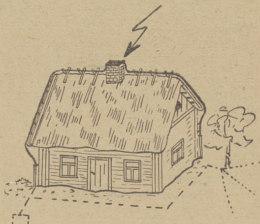
Piorunochron na budynku krytym słomą.
