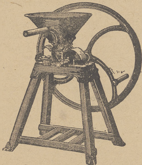
Rys. 2. Ręczny śrutownik walcowy:
